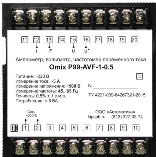
Рис. 13 – Задняя панель прибора P99
