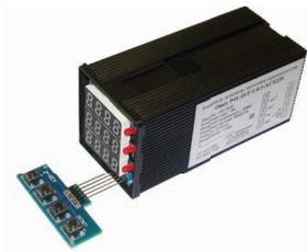
Рис. 15 – P44 с подключенной панелью программирования
